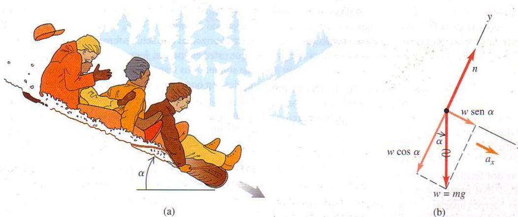
5.13 (a) Un tobogán cargado baja deslizándose por una colina sin fricción. (b) El diagrama de cuerpo libre muestra que la componente x del peso, w \sin \alpha , acelera el tobogán cuesta abajo.
